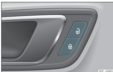
Fig. 75 Puerta del conductor: conmutador del cierre centralizado.
