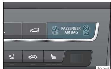
Fig. 16 Tablero de instrumentos: testigo de control de la desactivación del airbag del acompañante.
