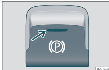
Fig. 175 En la parte inferior de la consola central: tecla del freno de estacionamiento electrónico.
