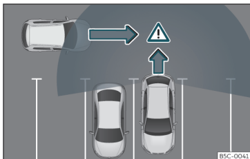
Fig. 174 Representación esquemática del asistente de desaparcamiento: zona vigilada alrededor del vehículo que está desaparcando.
