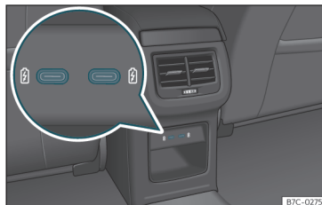
Fig. 138 Parte posterior consola central: conectores USB con función de toma de corriente.
