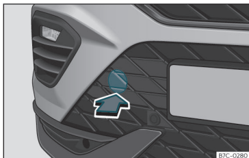
Fig. 41 En el lado derecho del paragolpes delantero: retirar la tapa.
