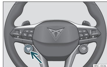
Fig. 147 Volante multifunción*: botón para cambiar el perfil de conducción.
