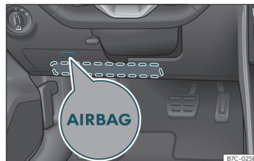
Fig. 17 En el lado del conductor: ubicación del airbag para las rodillas.
