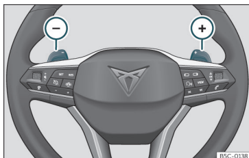
Fig. 144 Volante: palancas para cambio automático.
