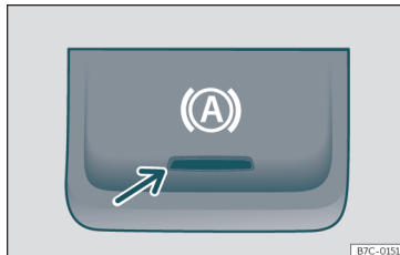
Fig. 176 En la parte inferior de la consola central: tecla de la función Auto Hold.
