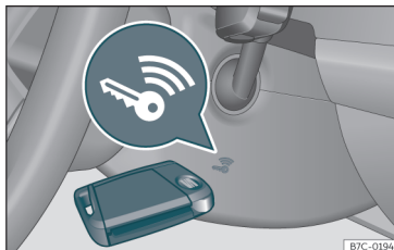
Fig. 140 A la derecha de la columna de dirección: arranque de emergencia.
