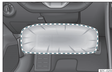
Fig. 18 En el lado del conductor: radio de acción del airbag para las rodillas.
