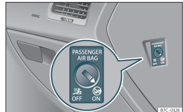
Fig. 15 Conmutador con llave para activar y desactivar el airbag del acompañante.
