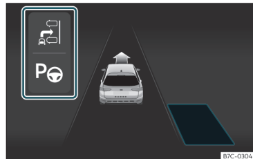
Fig. 178 En la pantalla del cuadro de instrumentos: visualización del sistema de aparcamiento asistido con visualización reducida.
