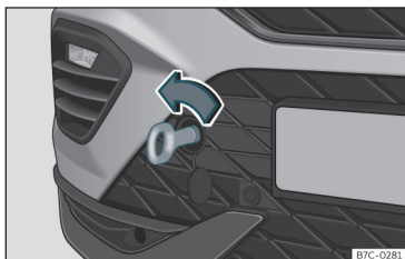
Fig. 42 En el lado derecho del paragolpes delantero: argolla de remolque enroscada.
