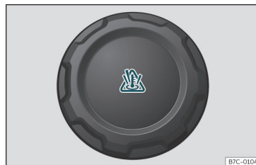
Fig. 205 Vano motor: tapón del depósito de expansión del líquido refrigerante.
