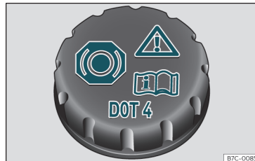
Fig. 206 Vano motor: tapón del depósito del líquido de frenos.
