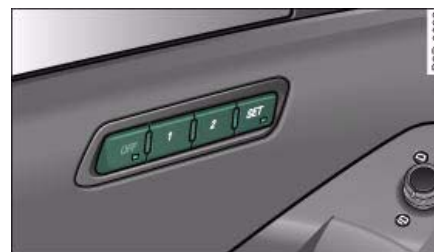
Fig. 65 Puerta del conductor: Teclas de memoria
