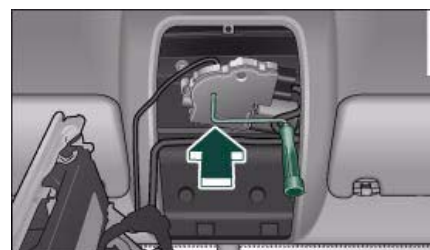
Fig. 37 Detalle del revestimiento del techo: Manivela para el accionamiento de emergencia
