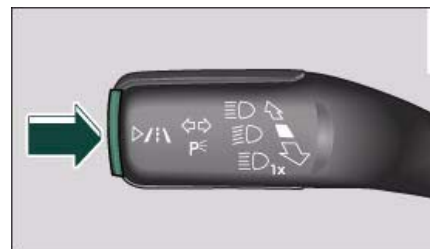
Fig. 128 Palanca de los intermitentes: Tecla para lane assist
