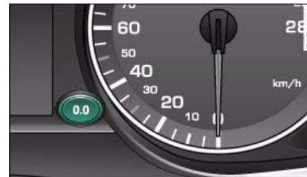
Fig. 6 Cuadro de instrumentos: Tecla de puesta a cero
