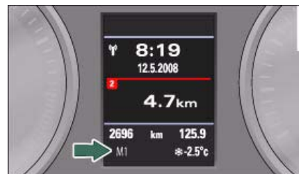
Fig. 148 Pantalla: Cambiar las marchas manualmente (tiptronic)
