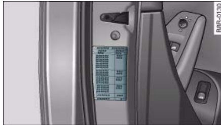
Fig. 216 Puerta del conductor abierta con la tabla de la presión de los neumáticos
