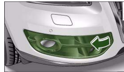
Fig. 239 Parte delantera derecha: Extraer la cubierta
