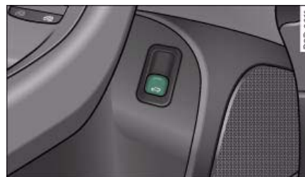
Fig. 30 Puerta del conductor: Desbloquear el portón del maletero
