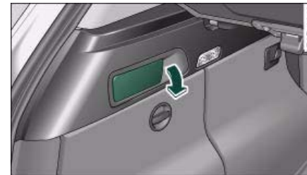
Fig. 87 Maletero: Palanca de desbloqueo
