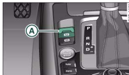
Fig. 103 Consola central: Freno de estacionamiento
