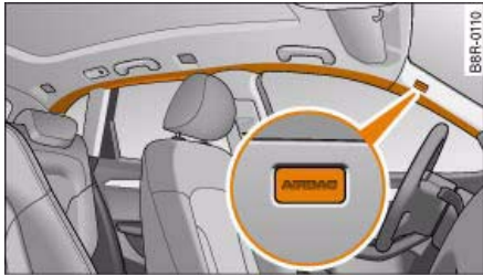
Fig. 185 Lugar de montaje de los airbags para el área de la cabeza: encima de las puertas
