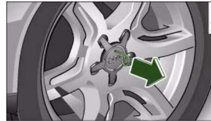
Fig. 229 Cambio de rueda: Quitar el tapacubos
