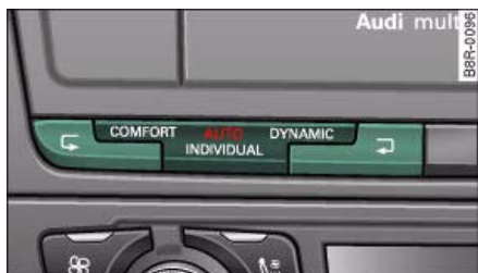
Fig. 143 Consola central: Mando del Audi drive select
