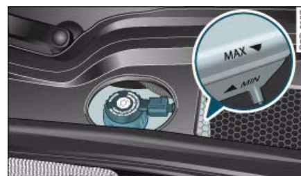
Fig. 213 Compartimento del motor: Marcas en el depósito del líquido de frenos
