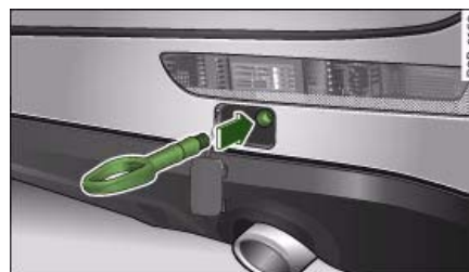
Fig. 242 Parachoques trasero: Enrosca la argolla de remolque
