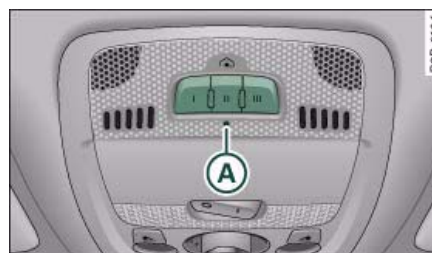
Fig. 162 Unidad de manejo en el revestimiento del techo
