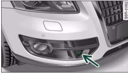
Fig. 108 Rejilla delantera derecha: Posición del sensor radárico
