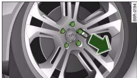
Fig. 230 Cambio de rueda: Retirar las caperuzas de adorno
