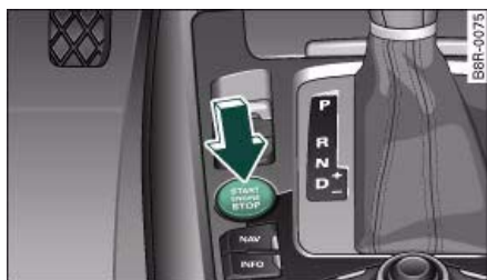
Fig. 102. Consola central: Tecla START/STOP
