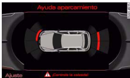
Fig. 153 Pantalla: Indicación óptica de la distancia
