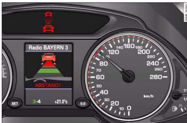
Fig. 119 Cuadro de instrumentos: Solicitud de intervención del conductor
