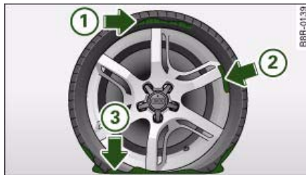
Fig. 227 El juego para reparación de neumáticos no es adecuado en este caso
