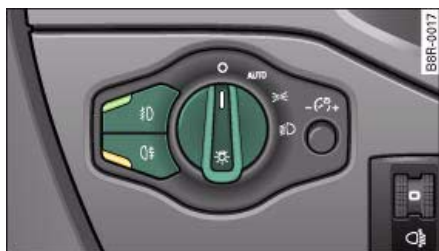
Fig. 38 Tablero de instrumentos: Conmutador de las luces
