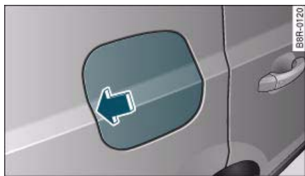
Fig. 204 Parte trasera derecha del vehículo: Abrir la tapa del depósito
