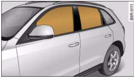
Fig. 186 Airbags para el área de la cabeza hinchados
