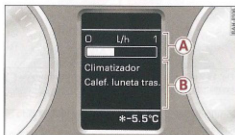
Fig. 17 Cuadro de instrumentos: Consumidores adicionales
