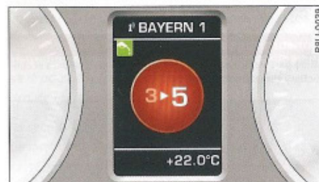
Fig. 16 Cuadro de instrumentos: Indicación ampliada de las marchas en vehículos con pantalla policroma
