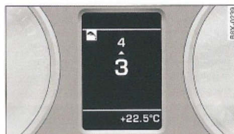
Fig. 15 Cuadro de instrumentos: Indicación ampliada de las marchas en vehículos con pantalla monocroma
