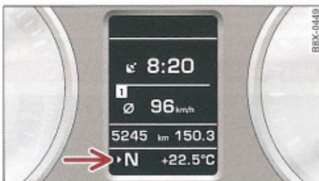
Fig. 8 Cuadro de instrumentos: Indicación de punto muerto
