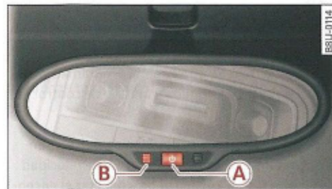
Fig. 48 Retrovisor interior con ajuste automático para posición antideslumbrante
