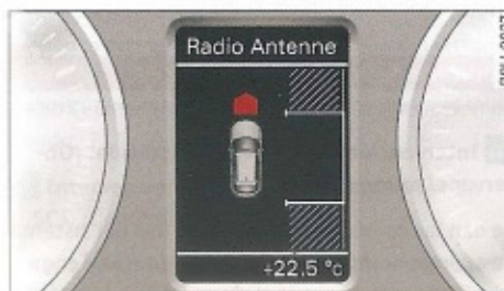
Fig. 128 Cuadro de instrumentos: Hueco detectado, con indicación de seguir marcha adelante
