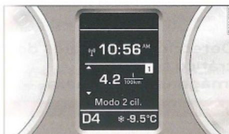
Fig. 19 Cuadro de instrumentos: Indicación del modo de 2 cilindros
