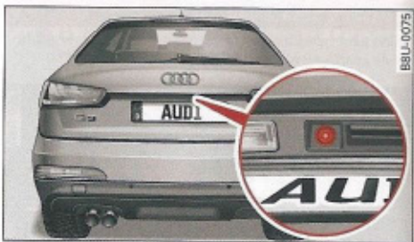
Fig. 119 Portón del maletero: Lugar de montaje de la cámara de marcha atrás
