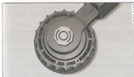
Fig. 173 Compartimento del motor: Marcas en el depósito del líquido de frenos
