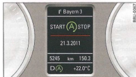
Fig. 84 Cuadro de instrumentos: Motor parado (fase Stop)
