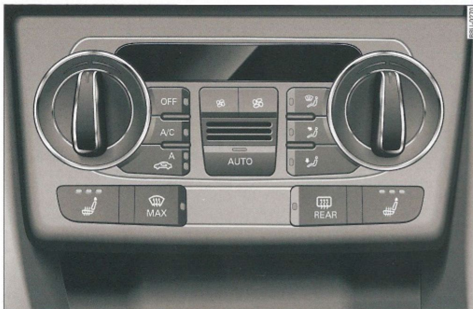
Fig. 79 Mandos del climatizador automático de confort
