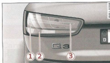
Fig. 207 Parte trasera del vehículo: Lámparas de incandescencia en el portón del maletero
