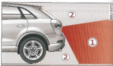
Fig. 118 Zona de detección ① y zona no detectada ② de la cámara de marcha atrás.
