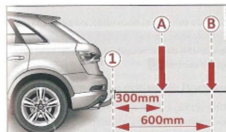
Fig. 95 Representación básica de la distribución de la carga de piezas suplementarias y accesorios
