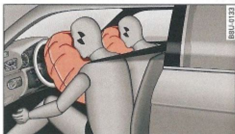
Fig. 154 Airbags frontales hinchados
