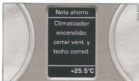
Fig. 18 Cuadro de instrumentos: Nota sobre el ahorro de combustible (ejemplo)
