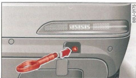
Fig. 203 Parachoques trasero: Enrosca la argolla de remolque
