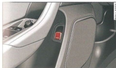
Fig. 33 Puerta del conductor: Abrir el portón del maletero
