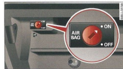
Fig. 160 Guantero: Interruptor de llave para desactivar el airbag del acompañante
