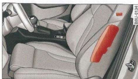
Fig. 156 Lugar de montaje del airbag lateral en el asiento del conductor
