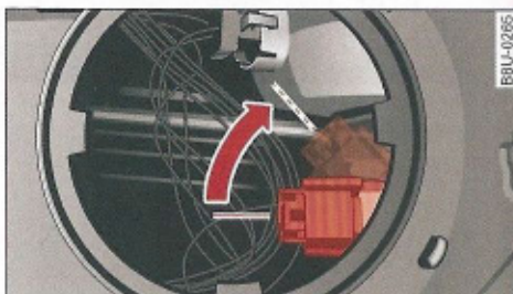
Fig. 212 Conector de plástico: Desmontar la luz para todo tiempo
