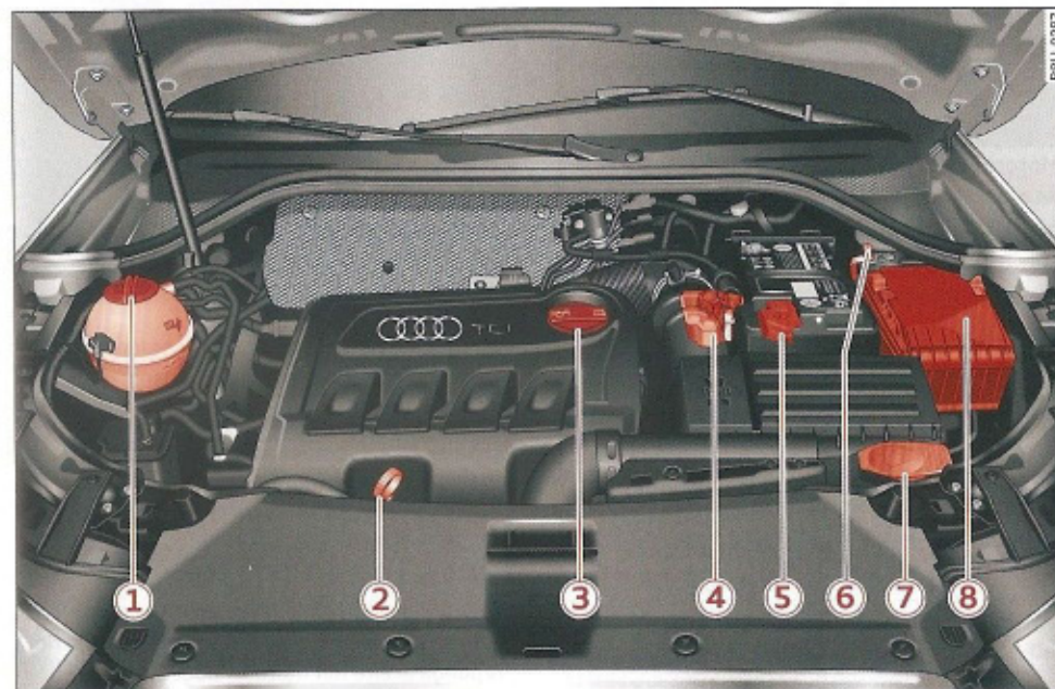
Fig. 169 Disposición típica de los depósitos y de la boca de llenado del aceite del motor
