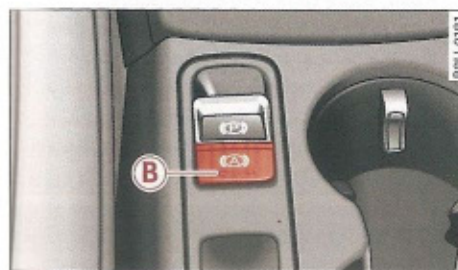
Fig. 88 Detalle de la consola central: Tecla para el sistema de asistencia en arrancada
