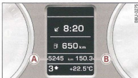
Fig. 6 Cuadro de instrumentos: Cuentakilómetros en vehículos sin sistema de información para el conductor
