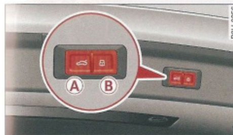
Fig. 34 Portón del maletero: A) Tecla de cierre, B) tecla de bloqueo (vehículos con llave de confort*)
