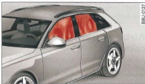
Fig. 159 Airbags para el área de la cabeza hinchados
