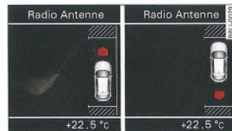
Fig. 130 Cuadro de instrumentos: Manobrar varias veces en un hueco para aparcar
