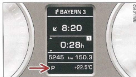
Fig. 89 Cuadro de instrumentos: Posiciones de la palanca selectora
