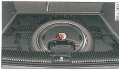
Fig. 196 Maletero: Rueda de repuesto de tamaño reducido (rueda de emergencia)
