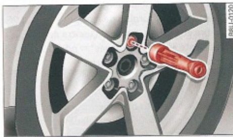
Fig. 194 Rueda: Util de hexágono interior para girar los tornillos
