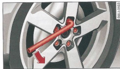
Fig. 191 Rueda: Aflojar los tornillos
