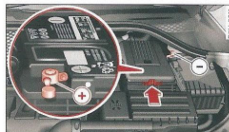
Fig. 174. Compartimento del motor: Conexiones para cargar y cable de ayuda de arranque
