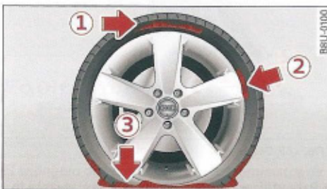
Fig. 186 Neumáticos: Daños irreparables en el neumático
