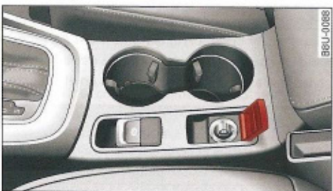
Fig. 63 Consola central delantera: Toma de corriente de 12 voltios*
