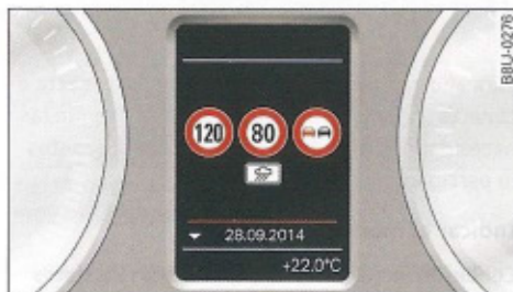
Fig. 20 Cuadro de instrumentos: Detección de señales de tráfico
