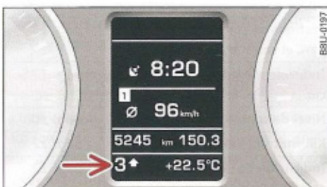
Fig. 7 Cuadro de instrumentos: Indicación de las marchas (ejemplo)
