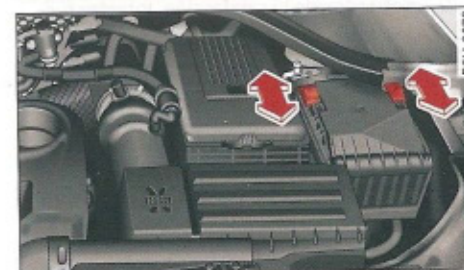
Fig. 205 Compartimento del motor: Desbloquear la tapa de fusibles
