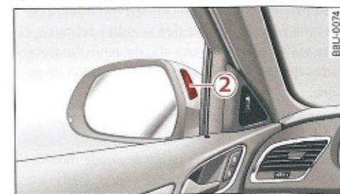
Fig. 107 Testigo en el retrovisor exterior
