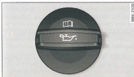
Fig. 171 Compartimento del motor; Tapón de la boca de llenado del aceite del motor
