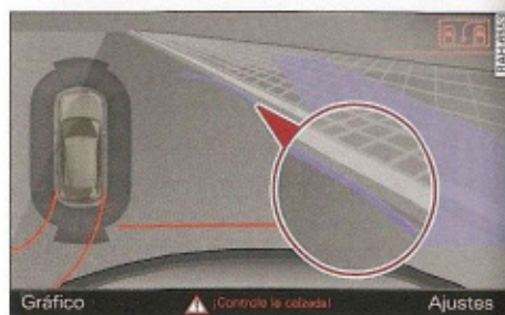
Fig. 123 Infotainment: Contacto de la curva azul con el bordillo
