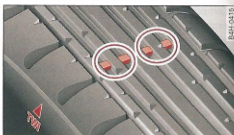
Fig. 177 Profundidad del dibujo: Indicador de desgaste
