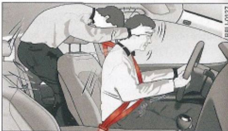
Fig. 144 El ocupante del asiento trasero que no lleve el cinturón de seguridad abrochado se verá lanzado hacia adelante.
