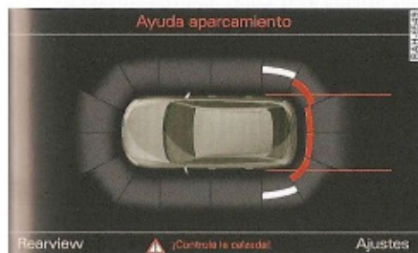
Fig. 115 Infotainment: Indicación óptica de la distancia
