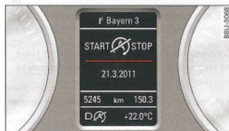
Fig. 85 Cuadro de instrumentos: Parada del motor no disponible temporalmente
