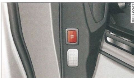
Fig. 31 Puerta del conductor: Tecla para los sistemas de vigilancia del habitáculo y de la protección contra el remolcado
