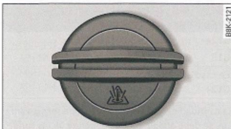
Fig. 172 Compartimento del motor: Tapa del depósito de expansión del líquido refrigerante
