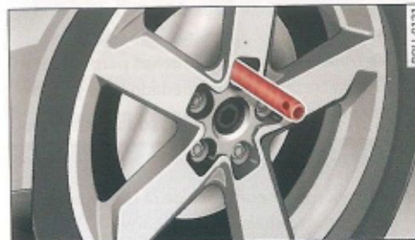
Fig. 195 Rueda: Pasador de montaje en el orificio superior
