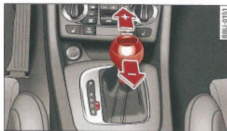
Fig. 91 Consola central: Cambiar las marchas manualmente con la palanca selectora
